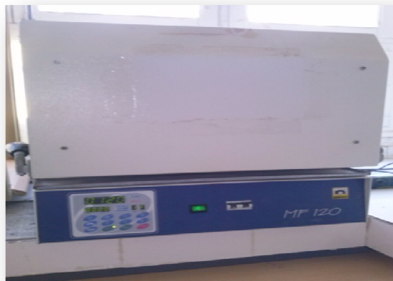
Figure V.7: Four utilisé pour le traitement thermique.
