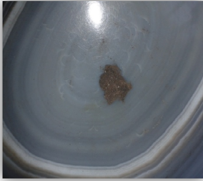
Ti/TMAOH=2/1 calciné à 400°C
