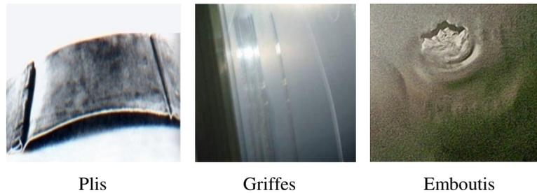
Fig. 1.14 : Exemples de griffes sur bande et autres endommagement mécaniques
