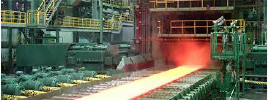
Fig. 2.2 : Illustration d'une sortie cage d'un procédé de fabrication à chaud des bandes d'acier. Environnement de hautes températures, de vapeur d'eau et d'encombrement mécanique,
