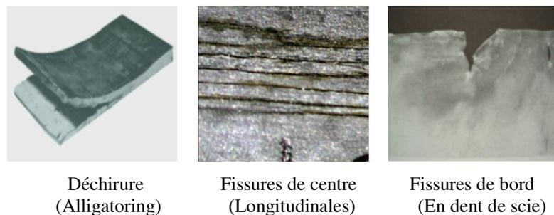
Fig. 1.11 : Exemples de fissures sur produits plats
