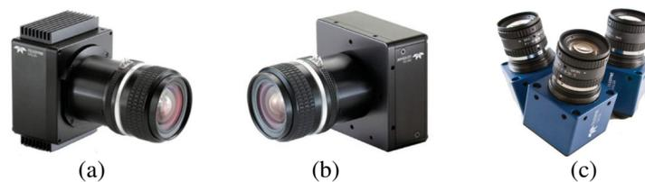
Fig. 2.5 : Caméras d'inspection : différentes conceptions et technologies (a)-Caméras Linéaire d'inspection : CCD/CMOS, Couleur/ monochrome,(1024 à 16384)x(1 à 3) pix, 9 à 80KHz, (b): Caméras Matricielles d'inspection, CCD/CMOS, Couleur/monochrome, (640 à 5344)x(480 à 4008) pix, 3.6 à 300Fps, (c)-Caméras Matricielles Intelligentes d'inspection : CCD, Couleur/monochrome, (640 à 1600)x(480 à 1200) pix, 15 à 60 Fps.
