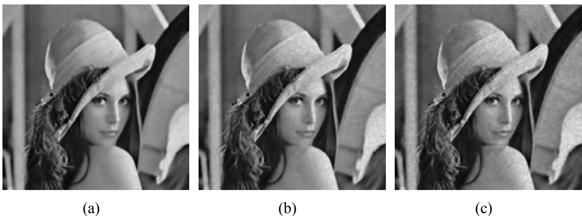
Figure IV.60: Reduction de speckle en utilisant le filtre SRAD, (a) Image débruitée pour SD 0.01, (b) Image débruitée pour SD 0.02, (c) Image débruitée pour SD 0.03.
