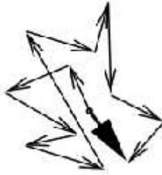
Figure III.5 : Dans le plan complexe, le signal reçu par un radar est en fait la somme des échos en provenance d'un grand nombre de diffuseurs.
