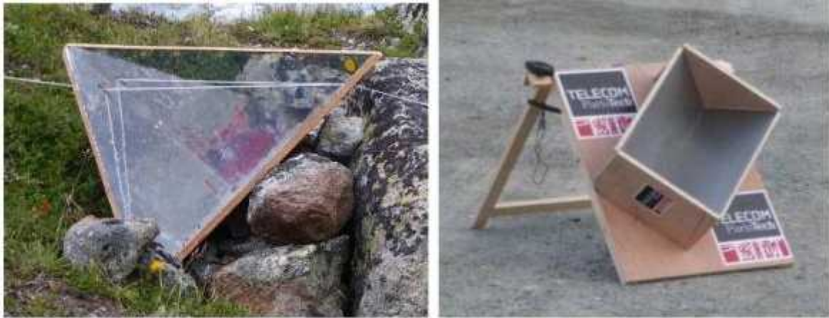
Figure III.1 : Cibles canoniques. A gauche, trièdre en bordure du glacier d'Argentière. A droite, dièdre dépolarisant en test à Argentière.
