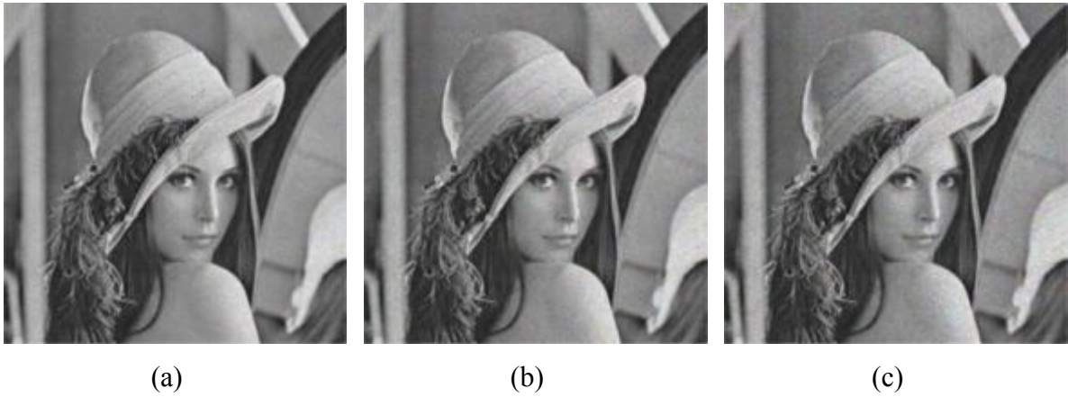
Figure IV.56: Reduction de speckle en utilisant le filtre de Frost, (a) Image débruitée pour SD 0.01, (b) Image débruitée pour SD 0.02, (c) Image débruitée pour SD 0.03.
