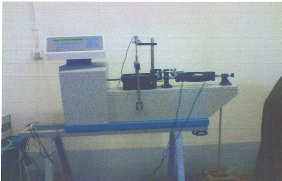
Photo 3.8 Dispositif de l'essai de cisaillement
