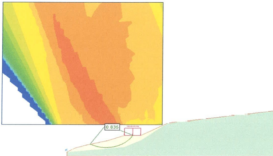
Figure 5.4 Coefficient de sécurité pour nombres de centres des cercles du glissement (20x20) obtenue par la méthode de Fellenius
