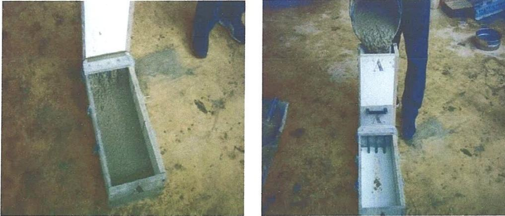
Figure 2.11 Essais d'écoulement à travers des armatures L-Box
