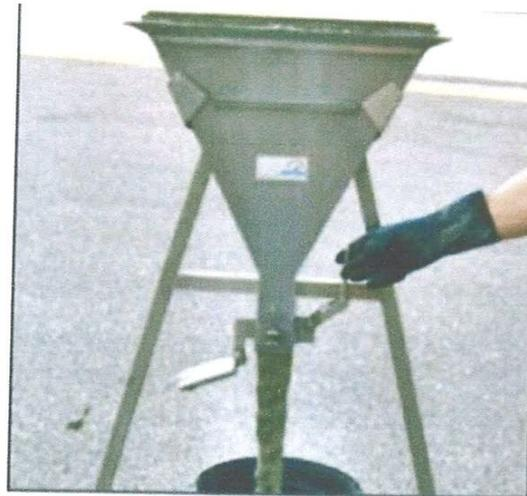
Figure 2.4 Essai d'entonnoir utilisé pour mesurer le temps d'écoulement du béton
