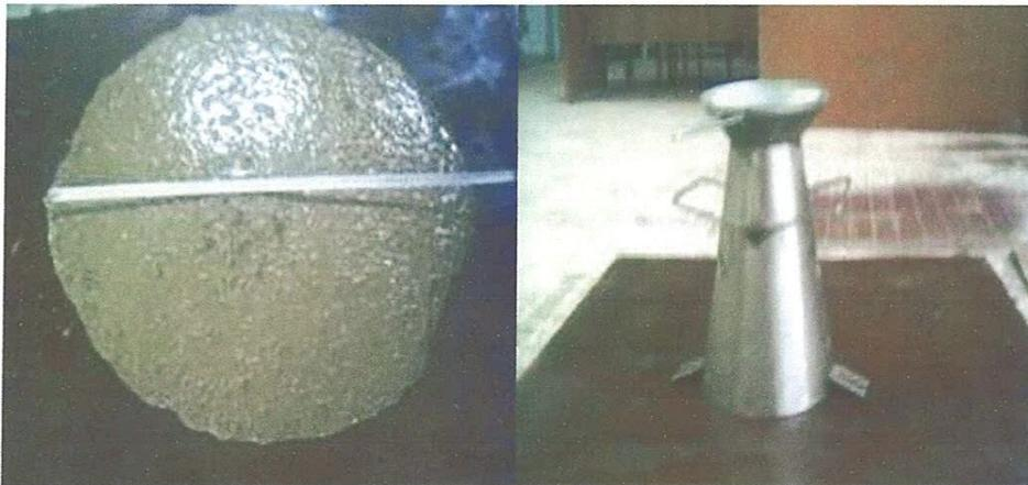
**Figure 2.8** Essai d'étalement au cône d'Abrams (slump flow)
