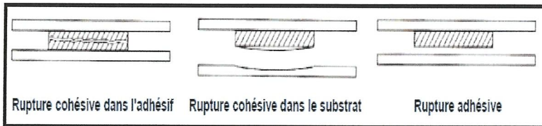
Figure V-1 Modes de rupture de joints collés.
