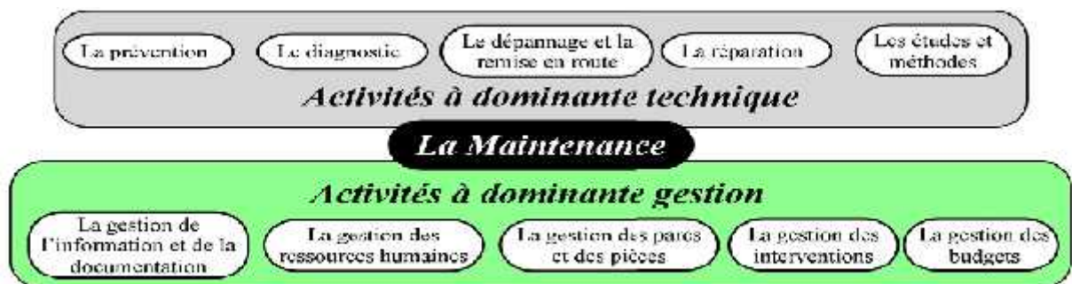
Figure I-1 : Contenu de la fonction maintenance
