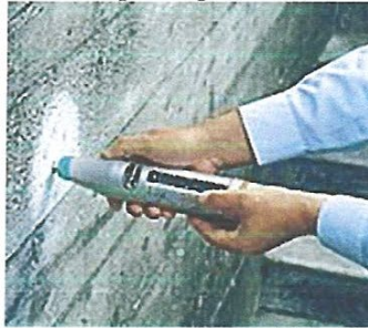
Fig 2.6 : Mesure au scléromètre
