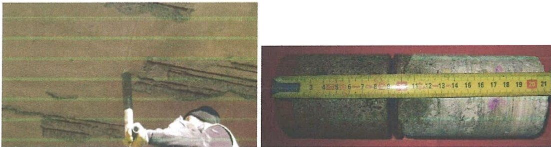
Fig 2.9 : Prélèvements par carottage
