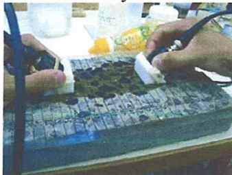
Fig 3.19: détermination de fissures par système automatisé
