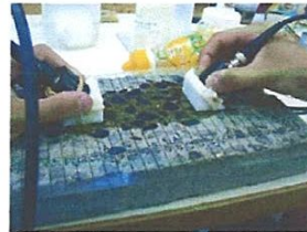
Fig 4.8a : Mesure en transmission indirect
