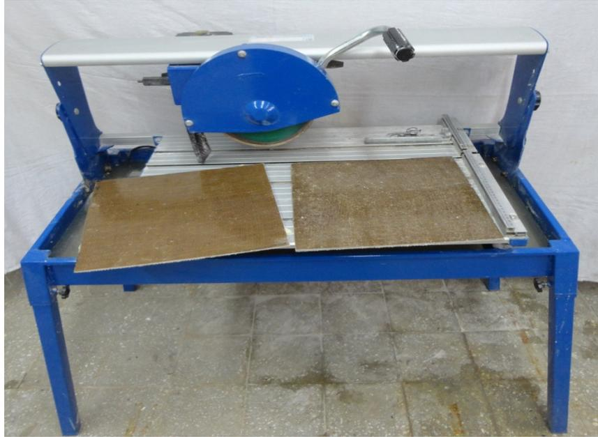
**Figure II.10** : Tronçonneuse à disque diamanté utilisée pour le découpage des plaques bio-composites en éprouvettes.
