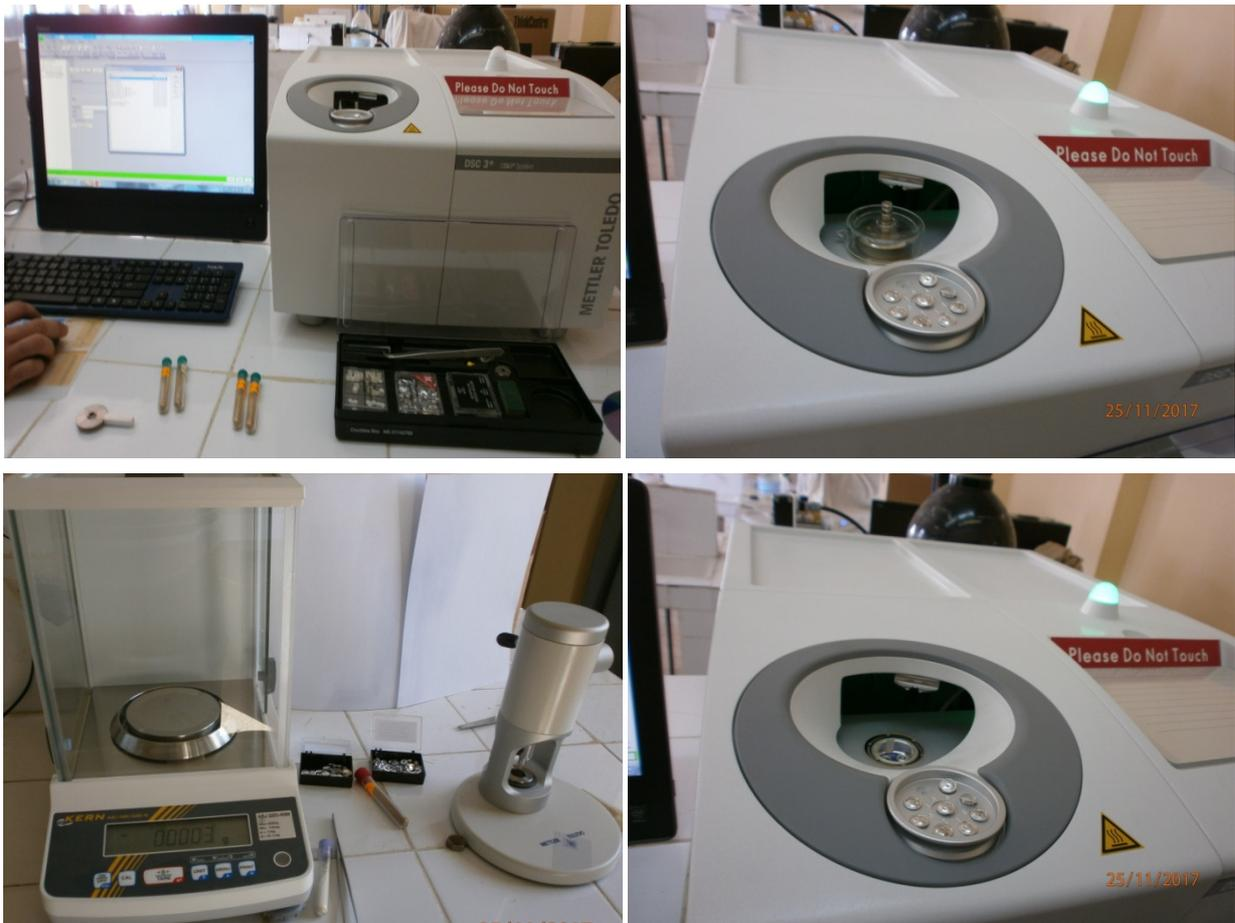
**Figure II.18** : Equipement utilisé en DSC de type **Mettler Toledo DSC 3<sup>+</sup>** (Labo LMANM Univ. Guelma).
