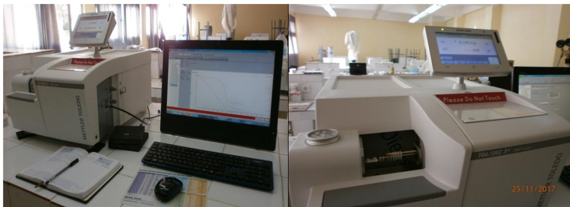
**Figure II.17:** Thermogravimétrie *TGA/DSC 3<sup>+</sup> Mettler Toledo* (Labo LMANM Univ. Guelma).
