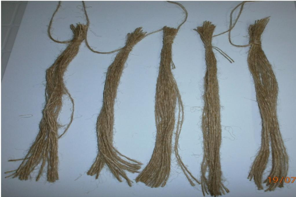
**Figure II.5:** Faisceaux de fibres de jute.
