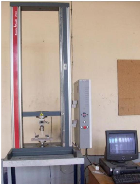
**Figure II.21** : Machine universelle de type **ZWICK ROELLE Z005**.
