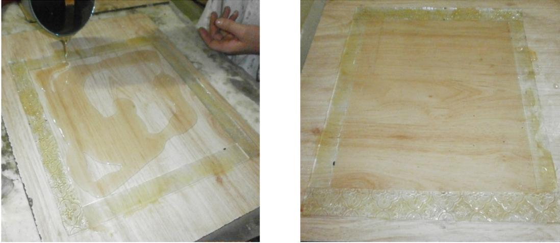
**Figure II.8:** Préparation des plaques en résine.
