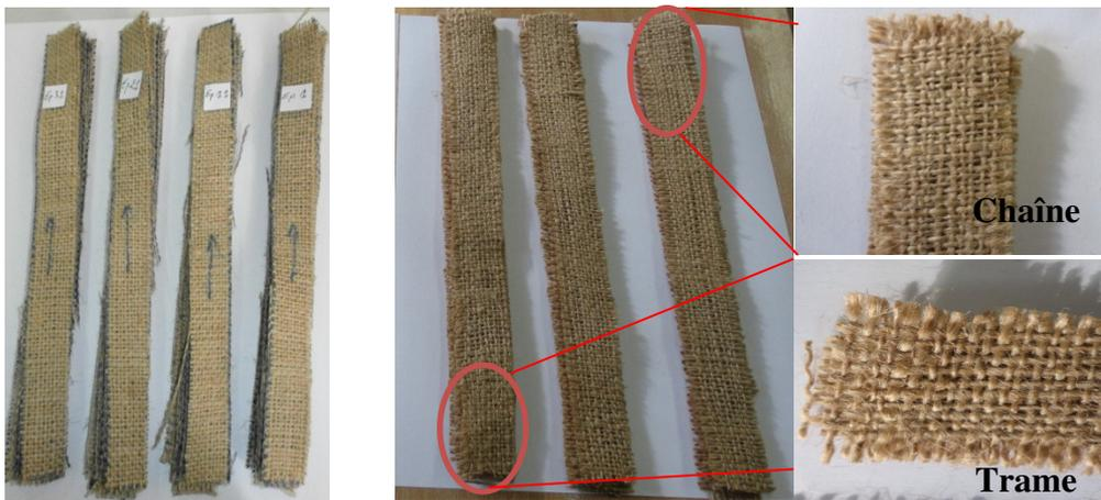
**Figure II.4:** Eprouvettes de traction du tissu de jute découpées dans les sens chaîne et trame.
