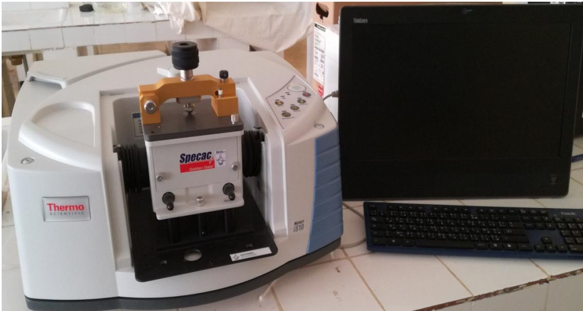
**Figure II.16:** Spectromètre Infrarouge de type *Thermo Scientific Nicolet Spectrum iS10* (Labo LMANM Univ. Guelma).
