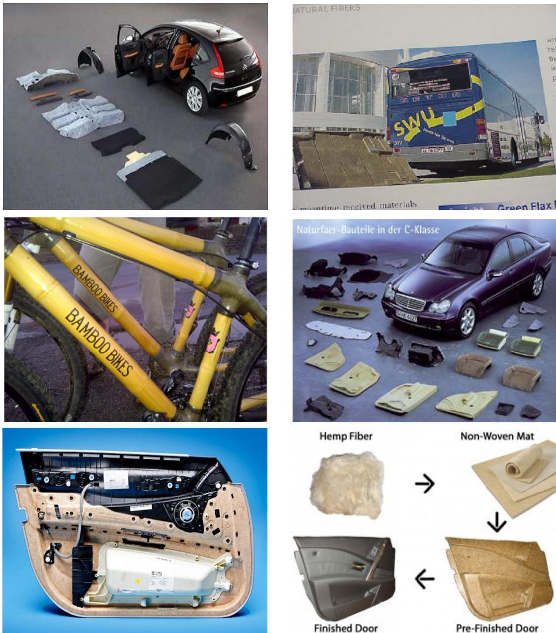
**Figure I.15 :** Application des matériaux composites à base de fibres naturelles dans le domaine d'automobile [SAX 11]
