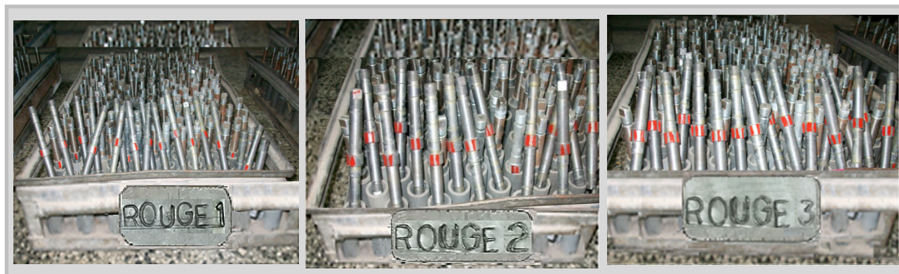
Figure 5.10 : Identification des lots de pièces pour de fins de transfert d'un poste de traitement à un autre
