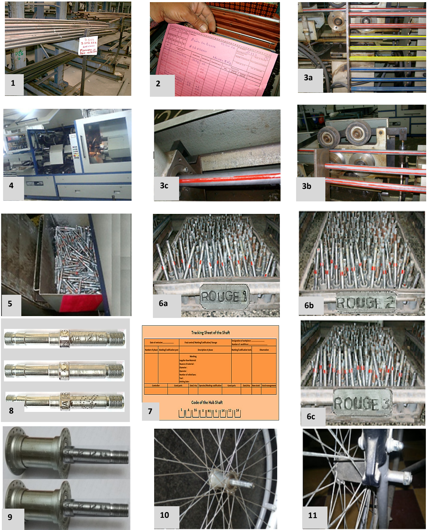
Figure 5.12 : Chemin de codification de l'axe de roue de fauteuil roulant, depuis la pièce brute jusqu'à la mise en service. [Rouabhia-Essalhi R et Amirat A, (2016)].
