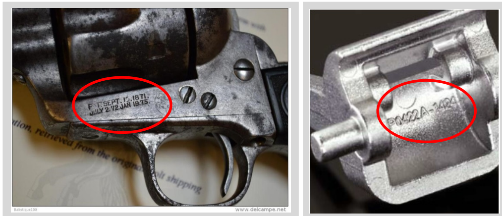
Figure 2.1. Numéros de série sur pièces mécaniques.
