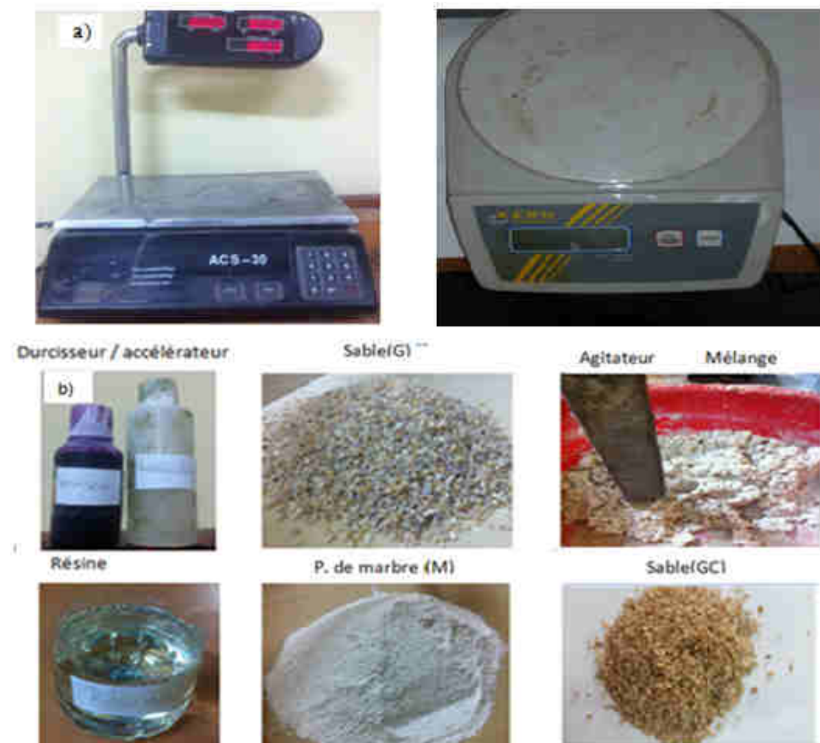
Figure 2.5: a) Balance de précision 5g, balance de précision 0,01g, b) Constituants du BP et processus de malaxage.
