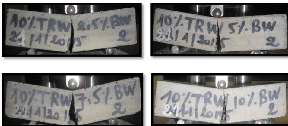
Figure 3.17: Mode de rupture des mortiers à base des GC traités (10%) et DB (2.5-10%).
