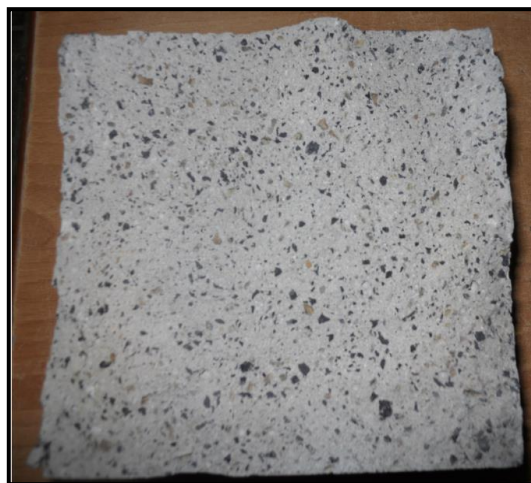
Figure 2.3: Distribution homogène des granulats de caoutchouc au sein des mortiers.
