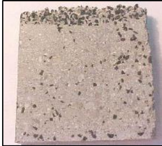
Figure 2.2: Ségrégation des granulats de caoutchouc au sein d'une matrice cimentaire [285].
