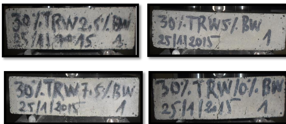
Figure 3.19: Mode de rupture des mortiers à base des GC traités (30%) et DB (2.5-10%).
