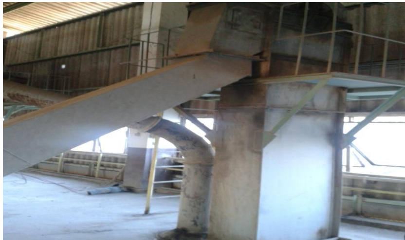
4/ Le kaolin descend avec une chaîne à godet dans la trémie souterraine, là où il est broyé.
