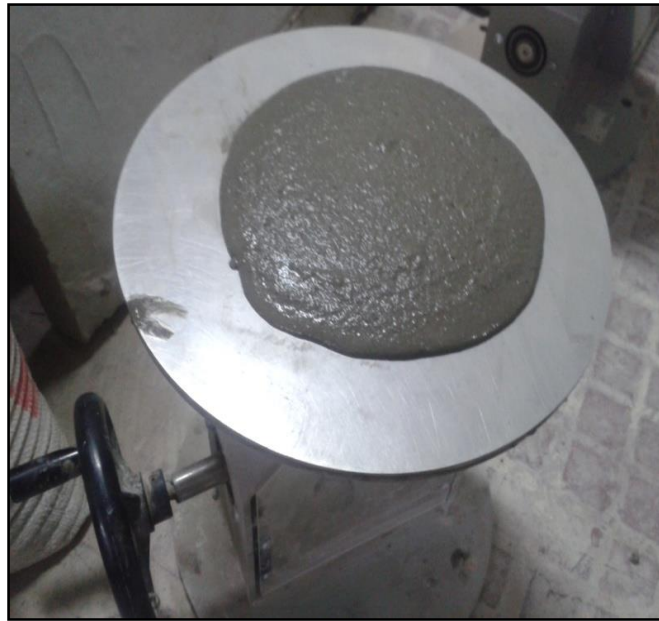
Figure 2.7 : Essai d'étalement des mortiers à la table à la secousse
