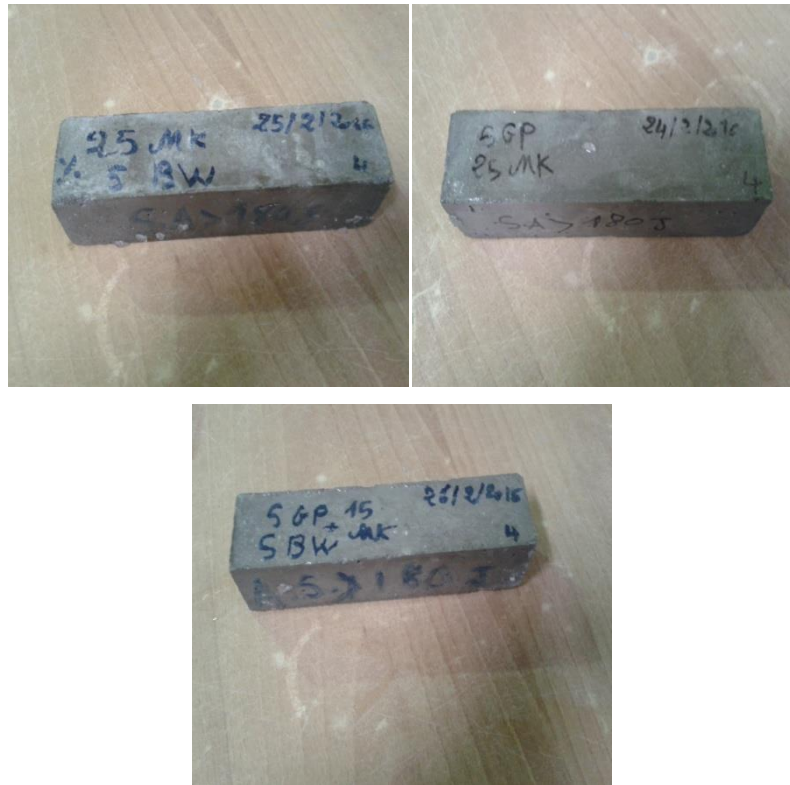
Figure 3.30 Eprouvettes du mortier à 25% de MK après 6 mois d'immersion dans la solution de \text{Na}_2\text{SO}_4
