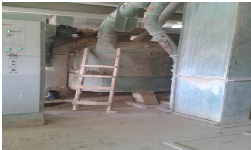
6/ Le kaolin remonte avec une chaîne à godet pour être broyer.
