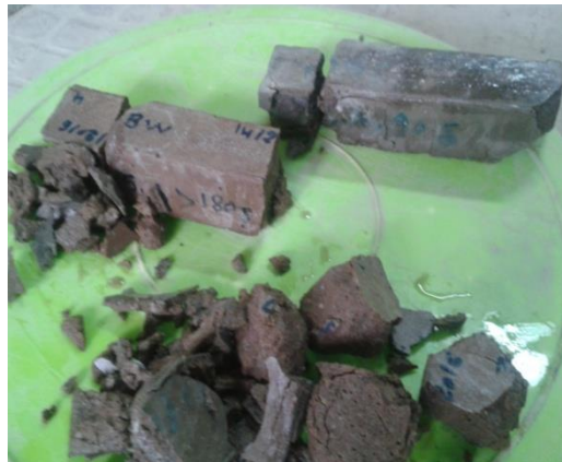
Figure 3.31 Eprouvette de mortier à 25% de BW à l'âge de 180 jours
