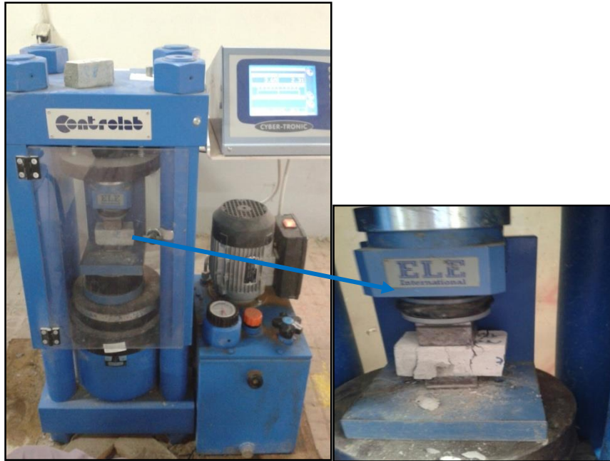
Figure 2.8 : Machine d'écrasement NF EN 1015-11
