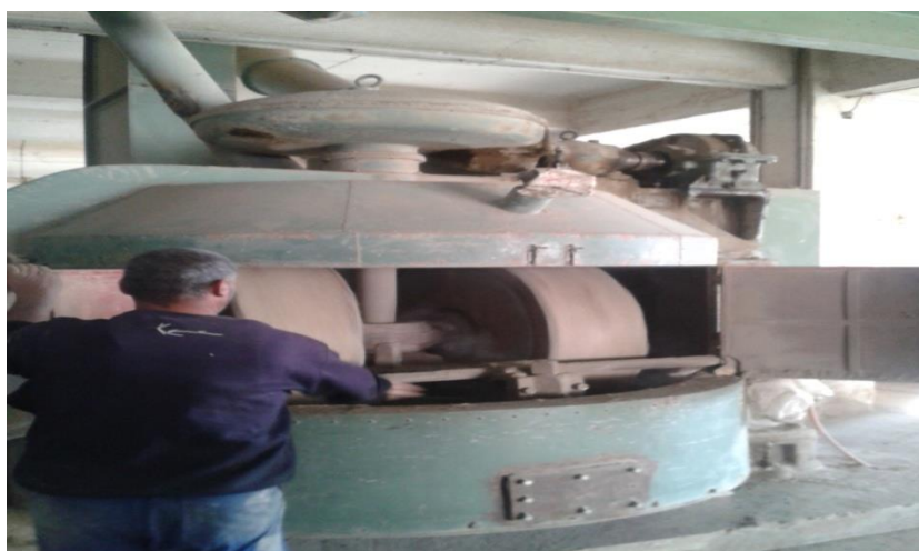
6/ Le kaolin remonte avec une chaîne à godet pour être broyer.
