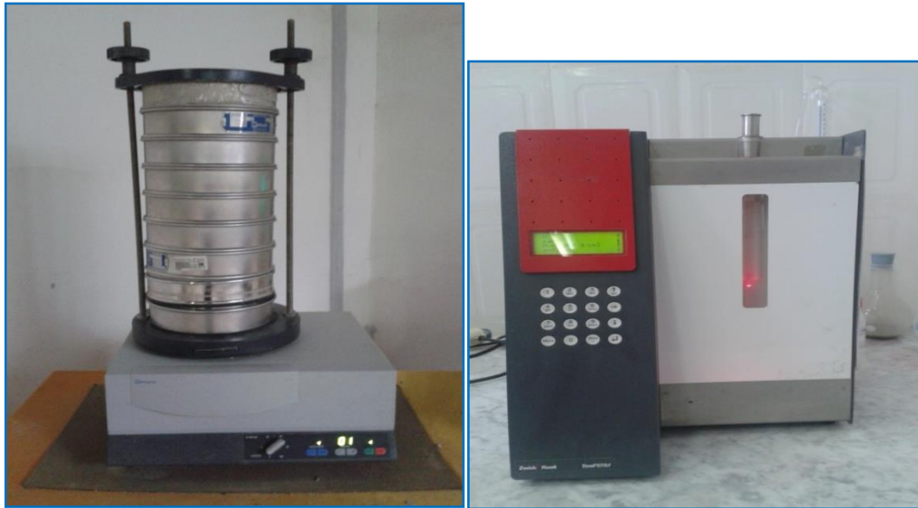
Figure 2.5 : Tamiseuse électrique et l'appareil de Blaine numérique
