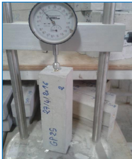
Figure 2.10 : Essai de retrait des mortiers à l'appareil de rétractomètre
