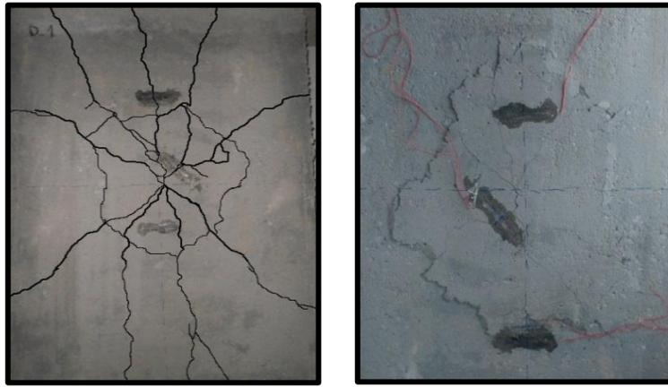
*Figure IV. 72. Rupture finale de la dalle non renforcée (D1)*
