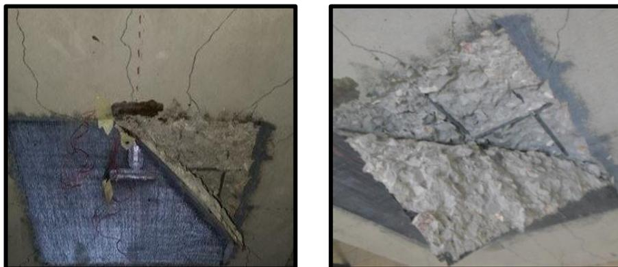
Figure IV. 91. Décollement de TFC (D14 et D15)
