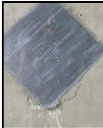
**Figure IV. 81.** Décollement du composite avec le béton (D8)
