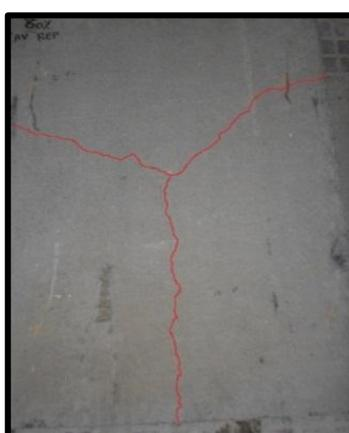
*Figure IV. 57. Fissures apparues dans la dalle pré-chargées à 60%*
