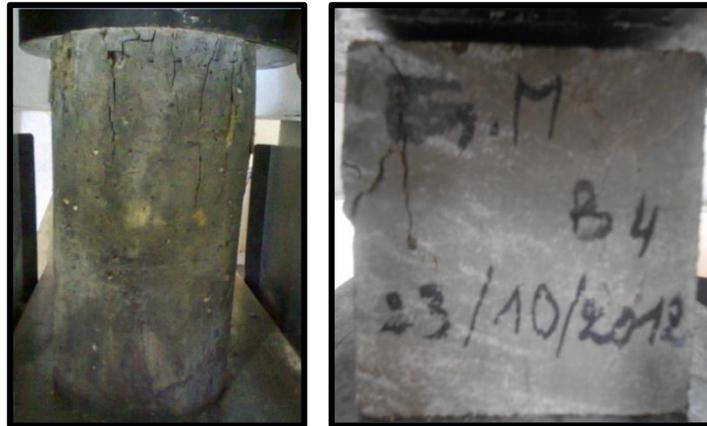
Figure III. 15. Test des éprouvettes (cylindrique et cubique)
