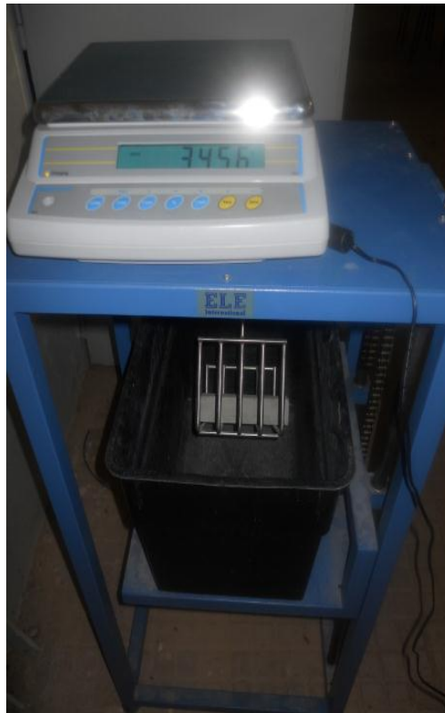
Figure III.4: Dispositif pour la mesure de la porosité accessible à l'eau
