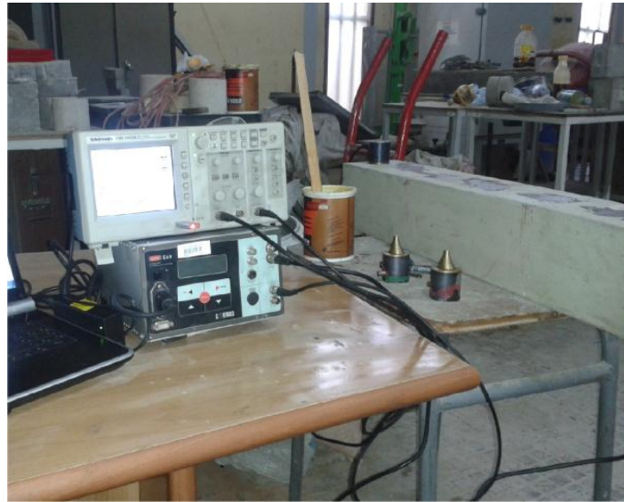
Figure III.2: Dispositif expérimental pour la mesure de la vitesse et de l'atténuation des ondes ultrasonores indirectes
