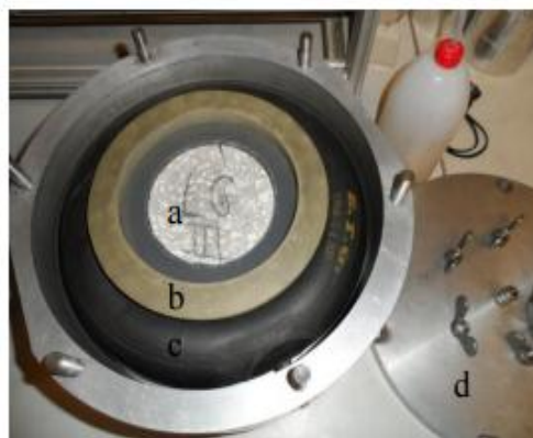
Figure III.6: Intérieur d'une cellule de perméabilité
