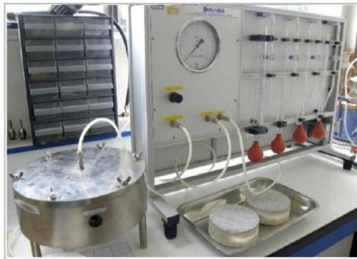
Figure III.5: Vue générale du perméamètre à gaz CEMBUREAU
