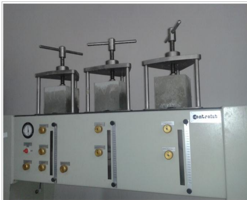
Figure III.7: Dispositif de mesure de la perméabilité à l'eau
