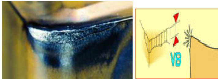
Figure I.17 Usure par abrasion [24]
