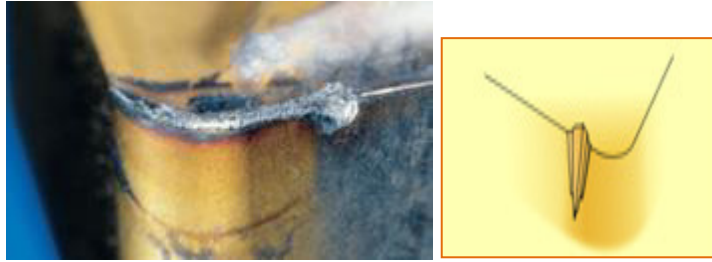
Figure I.20 Usure en entaille [24]
