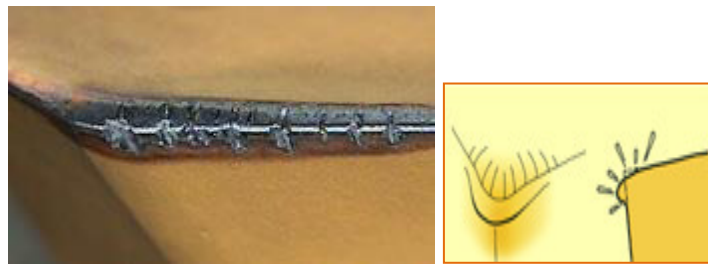
Figure I.22 Usure en peigne [24]
