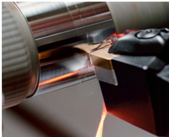
Figure I-5 Opération de chariotage du tournage dur ( Sandvik Coromant ).
