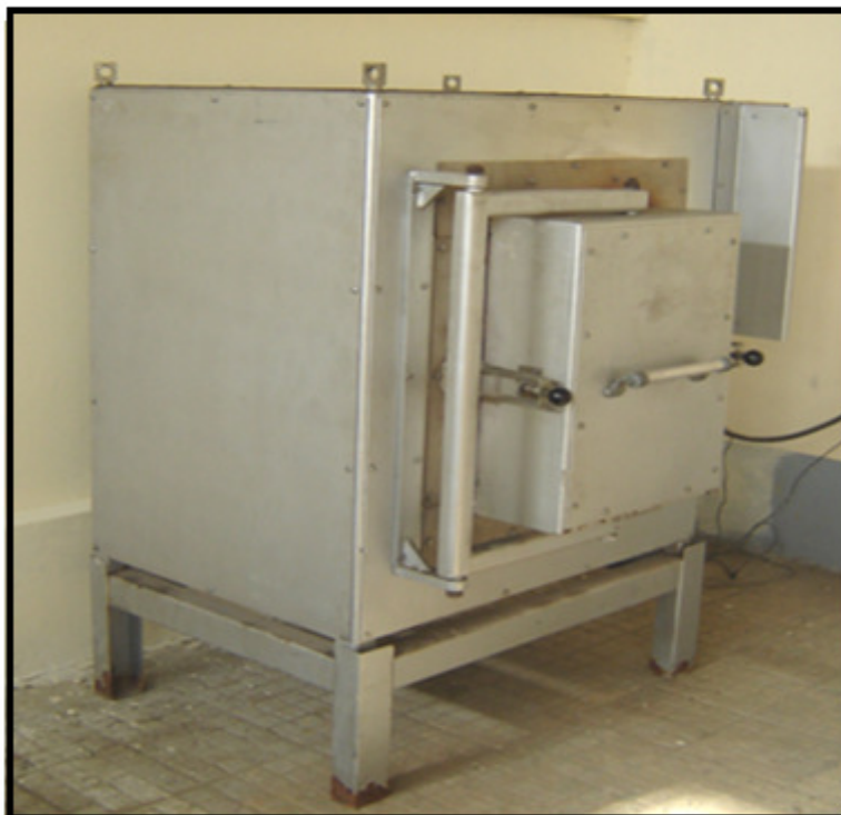
Figure III-7 Four à chambre électrique pour le traitement thermique des éprouvettes.
