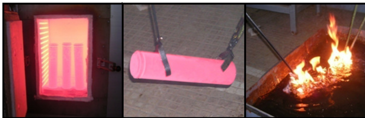
(a) Chauffage des éprouvettes (b) Transport de la pièce (c) Trempe à l'huile
