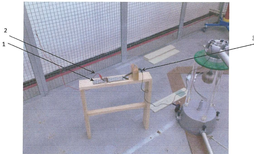
Fig.4.1. Modèle expérimental: (1) Plaque en verre; (2) Une électrode mise à la terre; (3) Une pointe conductrice mise à la borne haute tension
