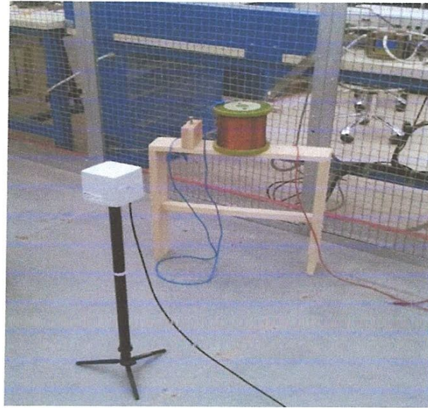
Fig.3.6. Mesure du champ magnétique de la bobine
