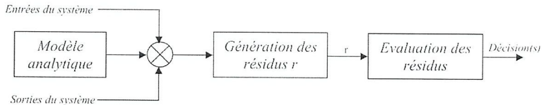
Figure II.11 : Schéma général de détection des défauts [31] [32]
