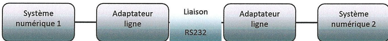
Figure 2.6 : schéma fonctionnel d'une liaison asynchrone de la norme RS232
