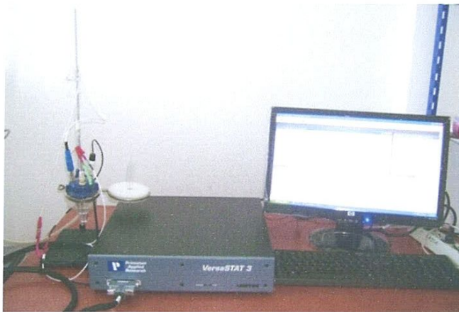
Figure III.7 : Montage de test de corrosion
