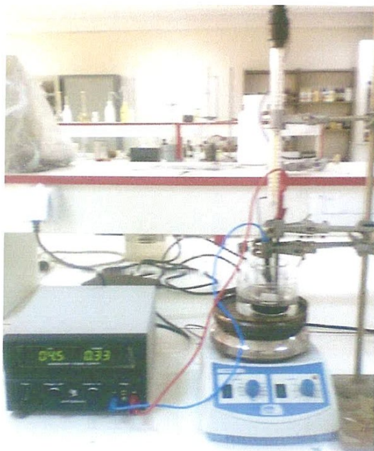
Figure III.4 : montage d'électrodéposition du chrome
