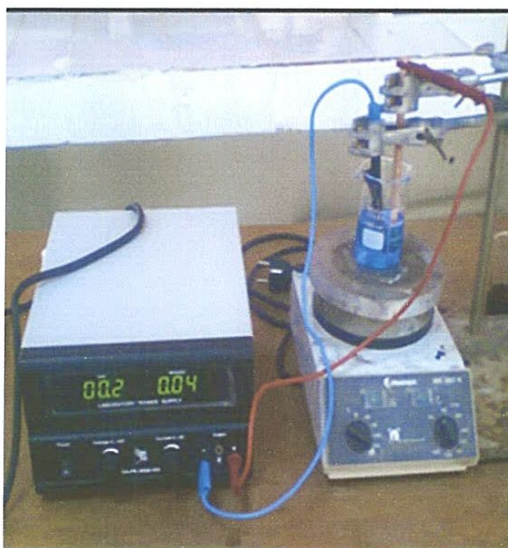
Figure III.3 : montage d'électrodéposition de cuivre
