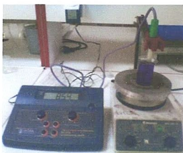
Figure III.1 : mesure de la variation des conductivités de la complexation \text{Cr}^{+3} -EDTA en fonction du temps
