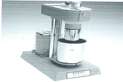
**Figure 23.** Rhéomètre de type **Fann**.
