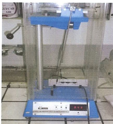
Photo IV.9 : Appareil de mesure de la dureté Persoz
