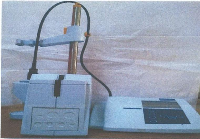
Figure IV.3 : Image d'un conductimètre.
