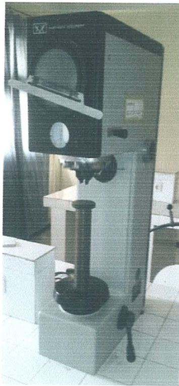
Fig. II.4 : Appareil de dureté (WOLPERT).
