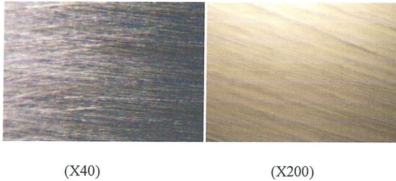
Fig. II.15 : Observation au Microscope Optique de la surface usée pour 100Cr6 trempé dans des faibles conditions.
