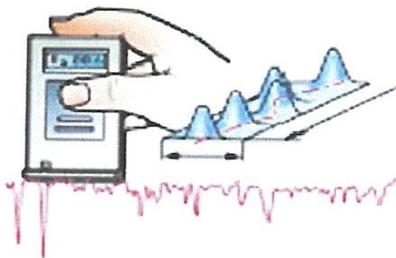
Fig- I-14 : mesure de rugosité
