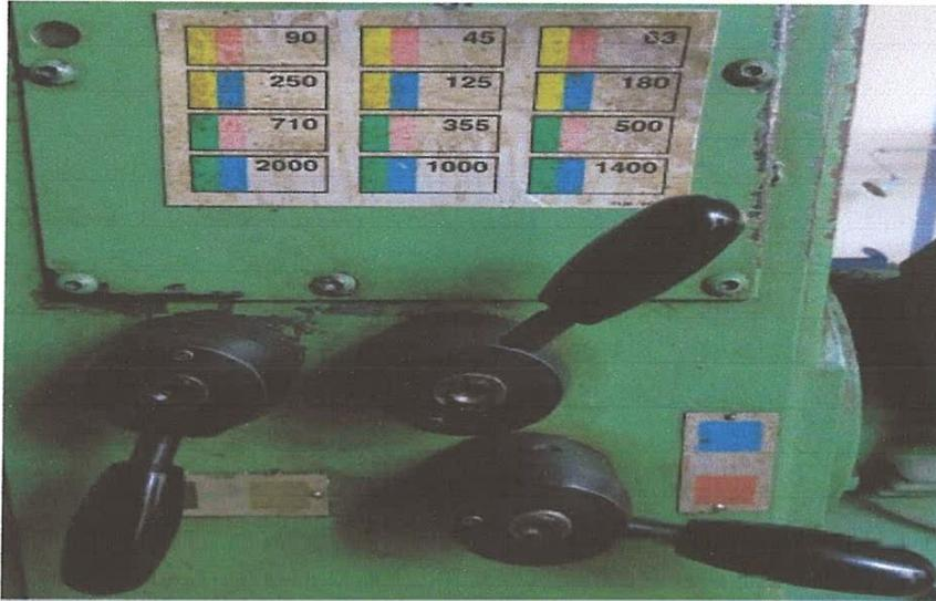
**Fig. II-2.** Fréquences de rotation de la machine outil
