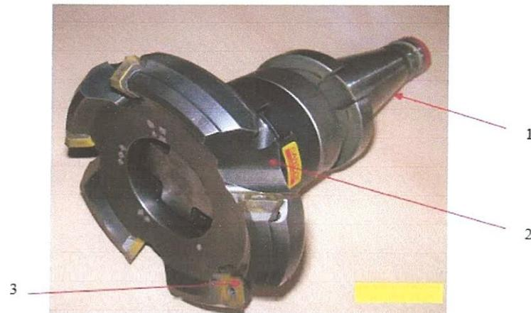
Fig. II-5 : Fraise à surfacer.
