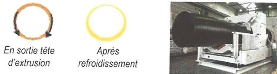
Figure 1-7 Forme de tube obtenue en polyéthylène[14].
