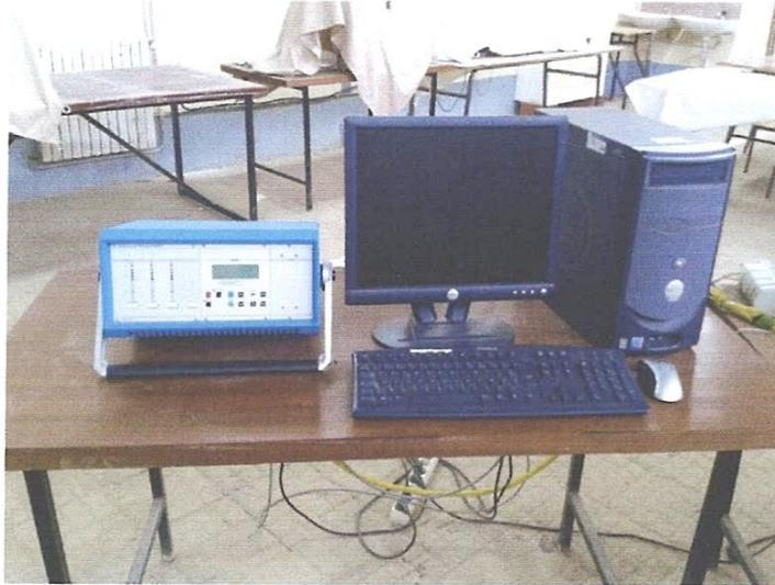
Figure III.4 : Amplificateur de charge Kistler 5019B et ordinateur
