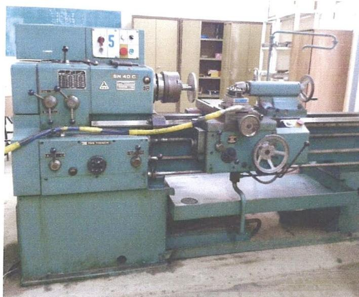
*Figure III.1 : Tour à charioter et à fileter modèle SN40C*
