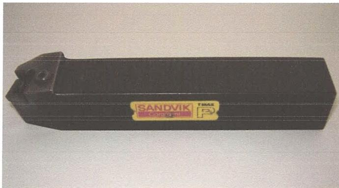
*Figure II-4 Porte outil utilisé.*
