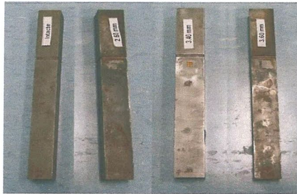
Fig. Poutre avec différentes tailles de fissures
