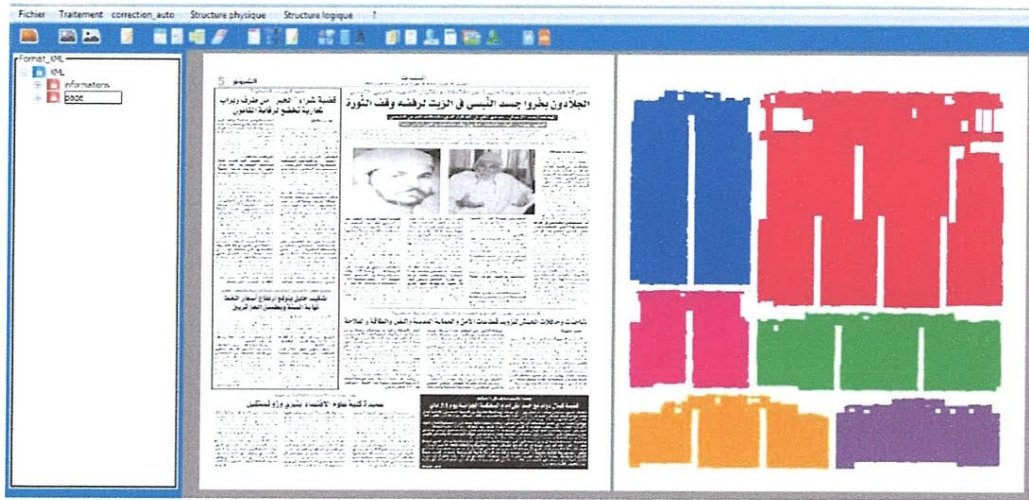
Figure 4.12 : Lissage par RLSA et étiquetage des composantes connexes.
