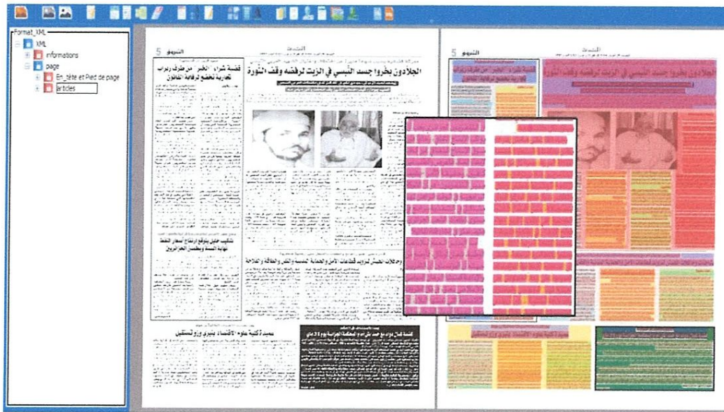
Figure 4.14 : Extraction des blocs, des lignes et des mots de chaque article.
