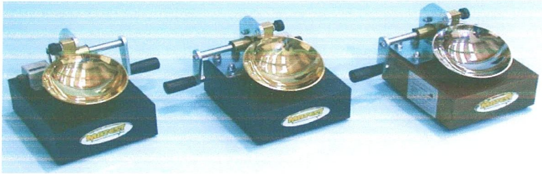
Figure I-7-2 : Appareil de Casagrande.
