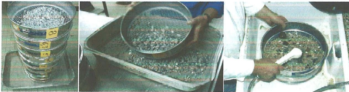
Figure I-1-2 : Lavage et tamisage de l'échantillon.
