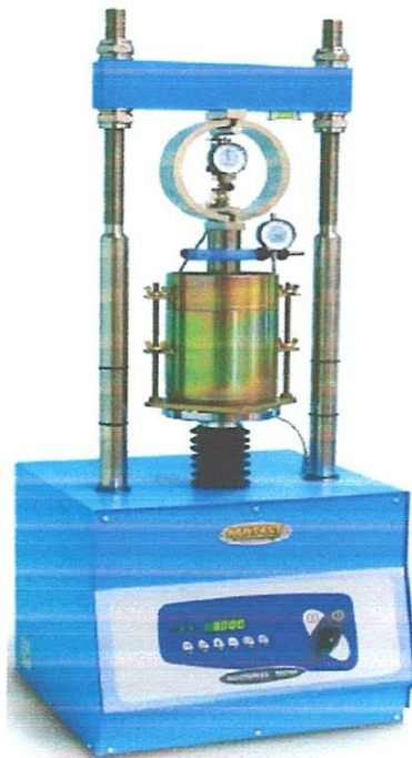
Figure III-2-1 : Matériel de confection des éprouvettes et de poinçonnement.
