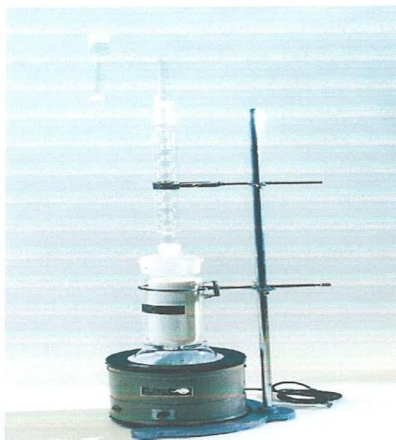
Figure III-7-2 : L'appareil de Kumagawa.
