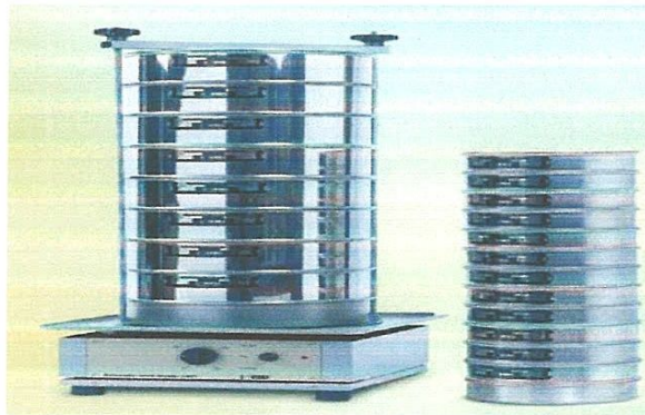
Figure I-1-1 : Photo d'une tamiseuse électrique.
