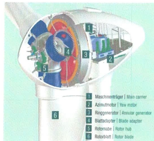
Fig.1.3.Éolienne sans multiplicateur
