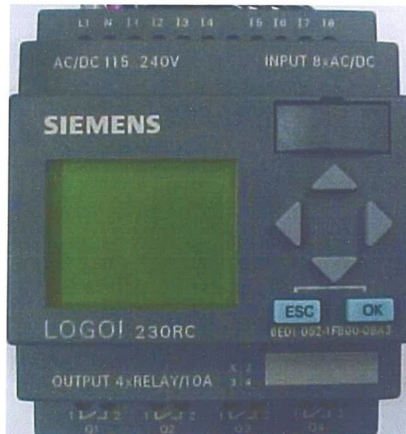
Figure II-2- Automate compact (LOGO de Siemens)
