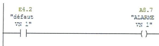
Réseau 22 : ALARME ELECTROVANNE 1
