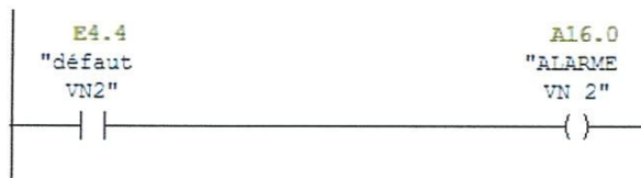
Réseau 23 : ALARME ELECTROVANNE 2
