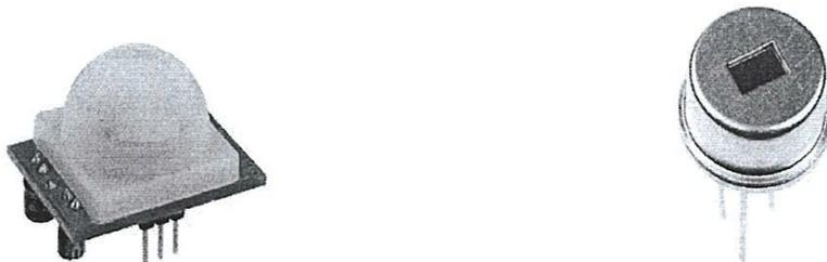
Figure III.10 : Capteur de mouvement (PIR)
