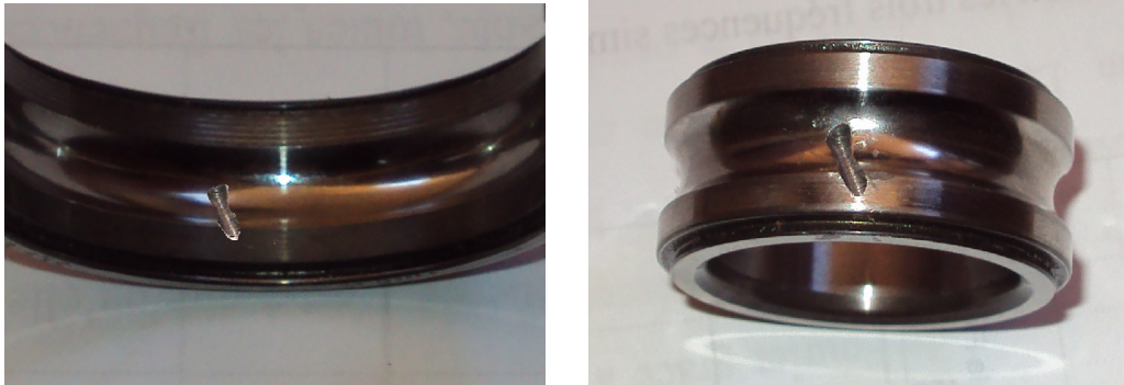
Figure 4.2. Photos de quelques défauts simulés (a) Bague extérieure (b) Bague intérieure
