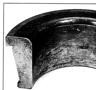
9 Corrosion de contact
