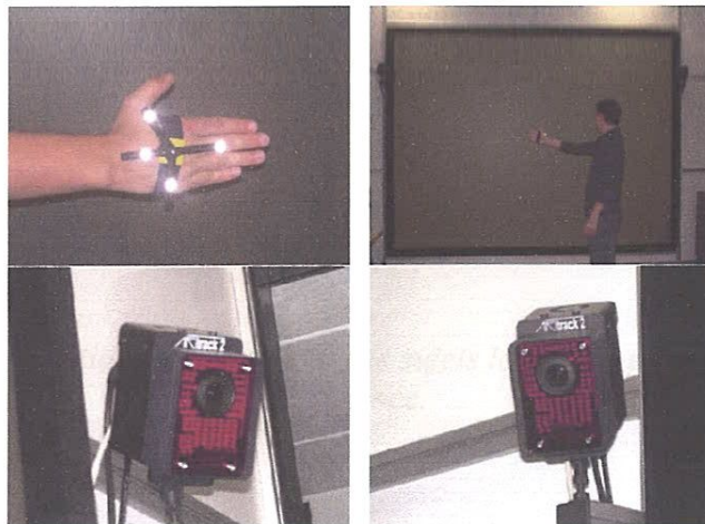
Figure 2.15 : Marqueurs sphériques rétro-réfléchissants placés sur la main du sujet pour en récupérer la trajectoire et caméras infrarouges optiques ARTtrack2 utilisées pour la capture de mouvement.
