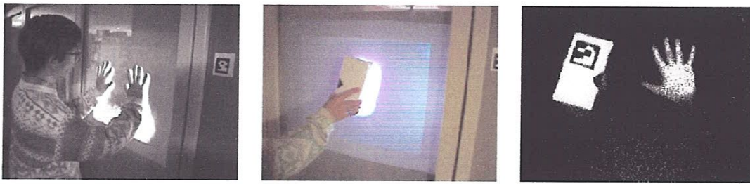
Figure 1.14 : Holowall en action: les mains (à gauche), bandes vidéo (au milieu), et une image capturée (à droite).
