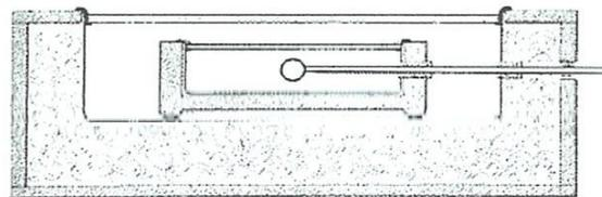
Figure I-3 : coupe transversale d'une « boîte chaude » avec thermomètre
