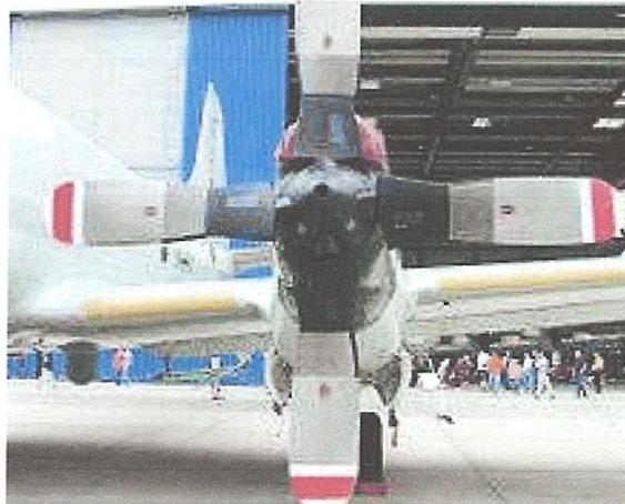
Figure 11. Hélice à pales à pas variable
