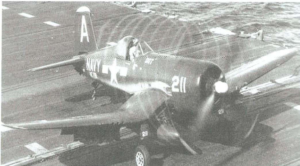
Figure 4: On peut voir ici le mouvement de « vis » créé par la combinaison rotation de l'hélice et déplacement de l'avion.
