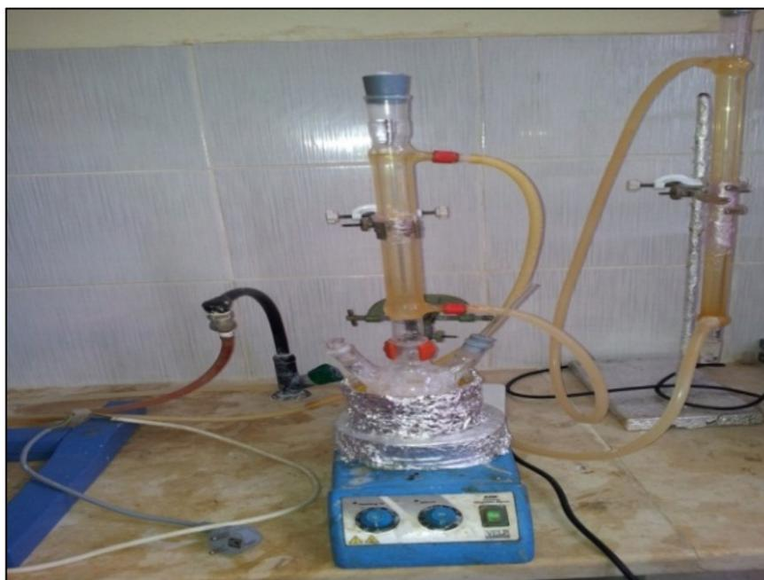
*Figure IV.1: Montage expérimental pour la préparation du complexe Kaolinite/DMSO (Laboratoire de Physique des Matériaux Lamellaires et Nanomatériaux Hybrides, faculté des sciences de Bizerte, Tunisie).*
