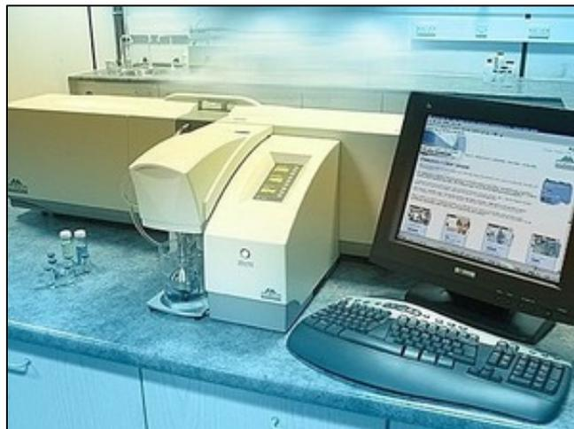
*Figure II.1: Photographie du granulomètre laser de type MALVERN Coulter (Laboratoire LAIGM).*
