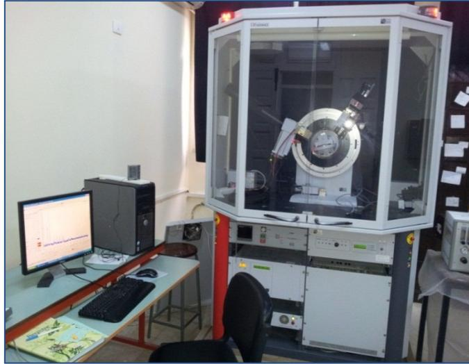
**Figure II.3:** Diffractomètre à poudre de type D8 Advance Bruker
