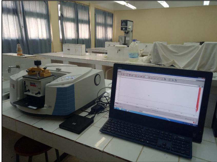
*Figure II.6: Photographie du spectrophotomètre FTIR de type Thermo Scientific Nicolet iS10 (Laboratoire LMANM, université de Guelma).*
