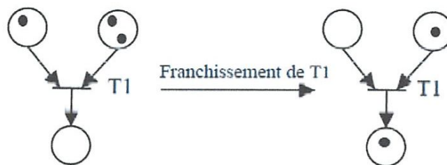
Figure 2.09 : Franchissement d'une transition.
