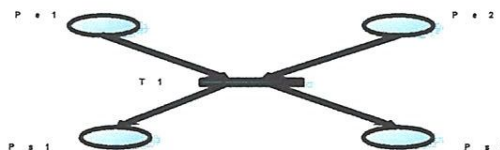
Figure 3.3 : La dynamique d'un réseau de Petri
