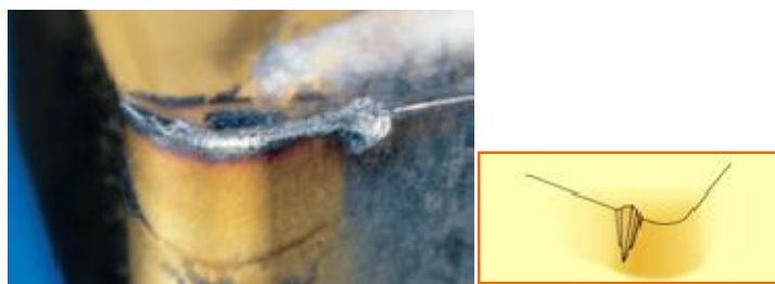
Figure I.12 : Usure par adhérence.
