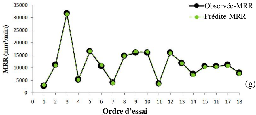
Figure V.8: Valeurs Observées vs. Prédites des paramètres technologiques: (a) rugosité de surface, (b) effort tangentielle, (c) effort spécifique, (d) puissance de coupe, (e) Vibration axiale, (f) vibration tangentielle et (g) volume de copeau enlevé.
