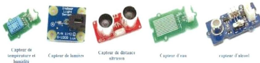
Figure I.17 : Différent types des capteurs pour l'Arduino
