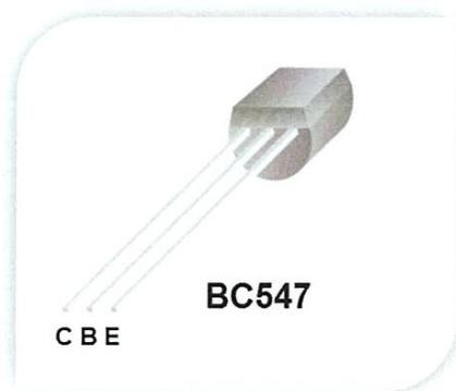
Figure II.22 : Brochage du BC547C-B-E (collecteur, base, émetteur)
