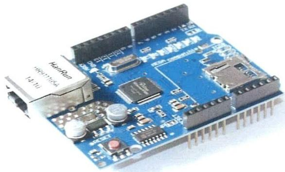
**Figure II.27 :** le module Ethernet
