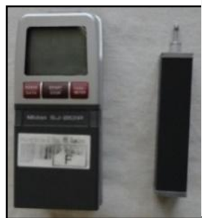
Fig. II.6. Rugosimètre Sj-201p (Mitutoyo)
