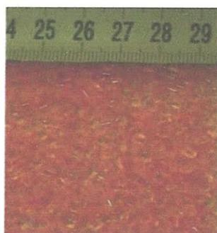
*Figure 4.4 : Echantillon des granules de polycarbonate (PC) utilisés.*
