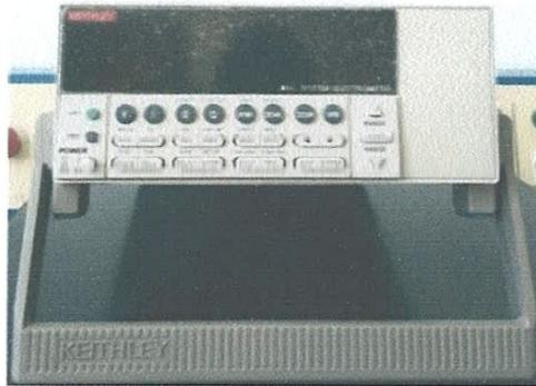
*Figure 3.7 : Electromètre numérique Keithley modèle 6514.*
