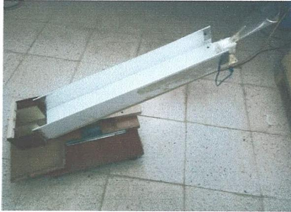
**Figure 4.7 : Séparateur à plan incliné réalisé au laboratoire LGEG.**
