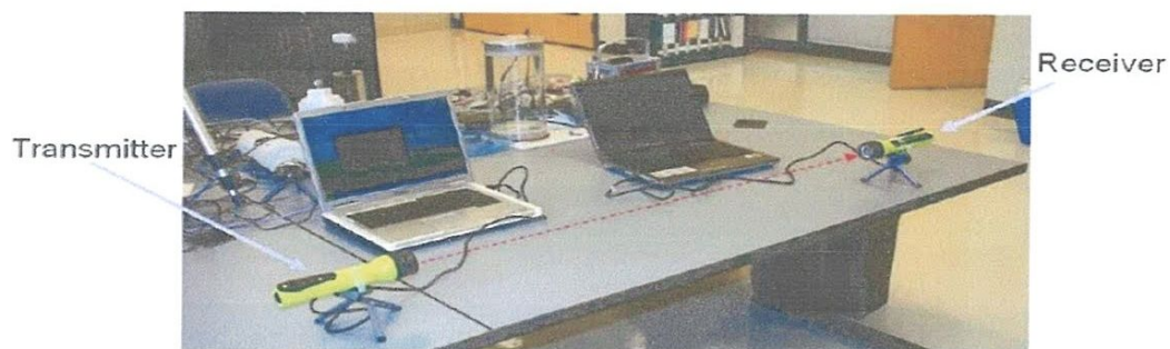
Figure III.11 Prototype VLC développée à l’université de Boston [12]
