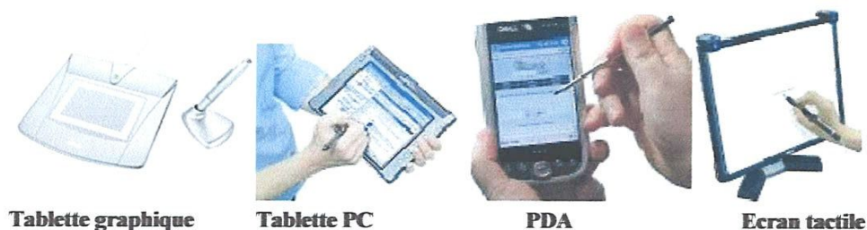
Figure I.4 : Dispositifs d'acquisition de la signature en ligne.
