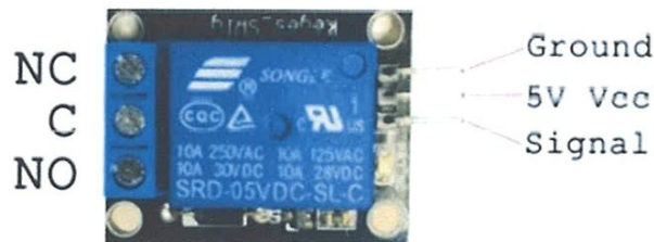
Figure 3.11 : Les bornes d'un relais 5v
