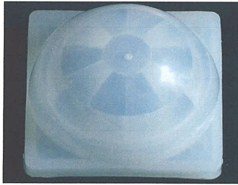
Figure 3.8 : Lentille de Fresnel multiple pour le PIR
